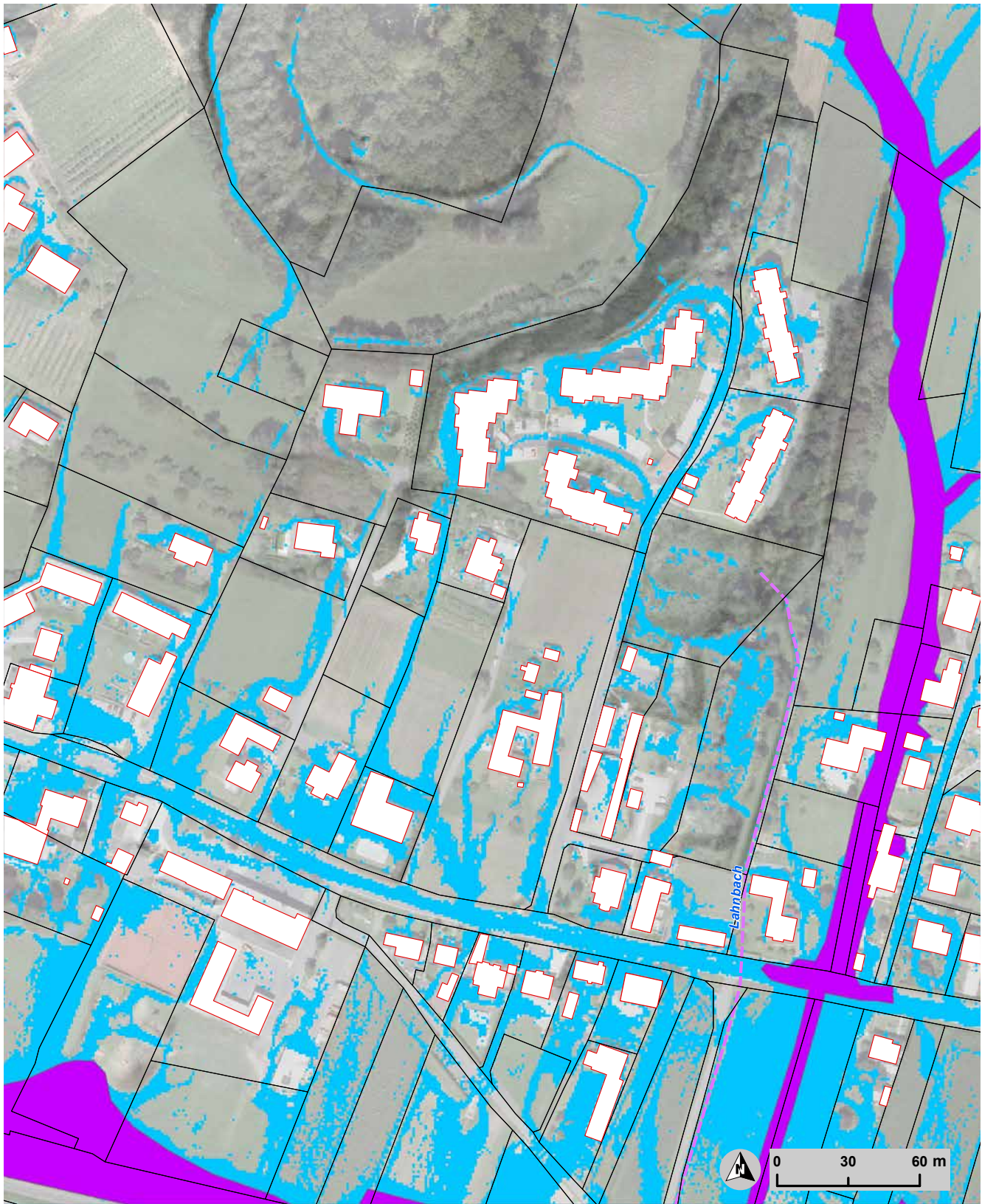
Abbildung 6: Auswertung der Auflagenbereiche anhand von Wassertiefe und Fließgeschwindigkeit
