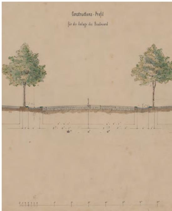
Abb.11: Constructions-Profil eines Boulevards von 1860 (Ausschnitt) - Steinpackung, beschotterte Fahrbahn, gepflasterte Rinnen; Stadt Graz.
